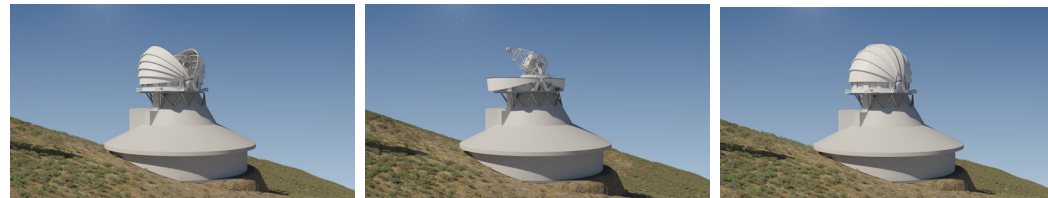
Fig. 4. EST con diversas configuraciones de su cúpula. Izquierda: Cúpula cerrada para proteger el telescopio de las inclemencias del tiempo. Centro: Cúpula abriéndose, donde se ven cómo los diferentes pétalos se van cubriendo unos a otros. Derecha: Cúpula completamente abierta para las observaciones rutinarias. EST operará en régimen abierto para que el viento pueda atravesar de manera natural la estructura del telescopio y pueda arrastrar la turbulencia generada por el calentamiento producido por la radiación solar. © IDOM.
