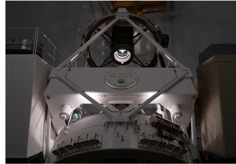
A la izquierda, el nuevo corrector de enfoque primario del Telescopio William Herschel, ahora equipado con una de las lentes astronómicas más grandes jamás construidas. © Kane Sjöberg. A la derecha, una imagen JWST con el WEAVE LIFU apuntando al Quinteto de Stephan para la observación con las primeras luces. El LIFU recoge luz de 547 puntos del cielo para su análisis mediante el espectrógrafo WEAVE (cada círculo indica una fibra óptica de 2,6 segundos de arco de diámetro). © NASA, ESA, CSA, STScI (imagen de fondo). Esta composición ha hecho uso del "Atlas del cielo de Aladin" desarrollado en el CDS, Observatorio de Estrasburgo, Francia.
