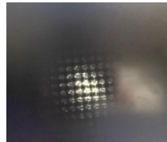
Imagen recibida en el Wavefront sensor plenoptico ubicado en la OGS del OT, tras la recepción de un láser de 1590 nm emitido desde el ORM. En esta actividad se tomaron datos que sirvieron para caracterizar la atmósfera y medir la turbulencia.
