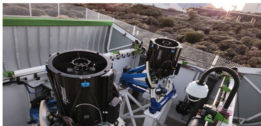
Los telescopios LCO de 0,4 m mejorados en el OT. Los telescopios DeltaRho son visibles en la base del LCO dentro del recinto con la cúpula tipo concha abierta (fabricada por Aqawan).
