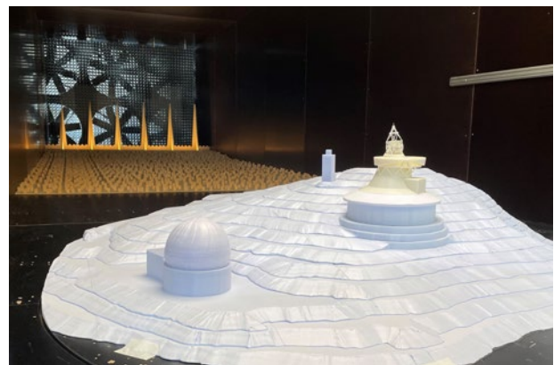
Pruebas en túnel de viento modelo del telescopio en ORM.
