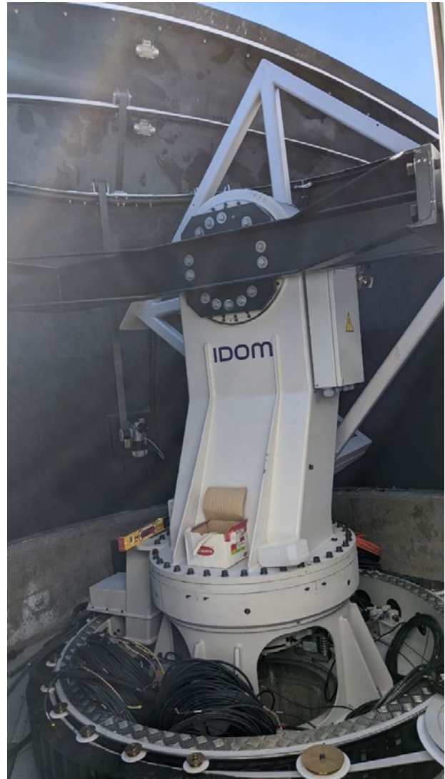
Pedestal de TMS, instalado en el Observatorio del Teide dentro de la cúpula del instrumento. Noviembre 2022.
