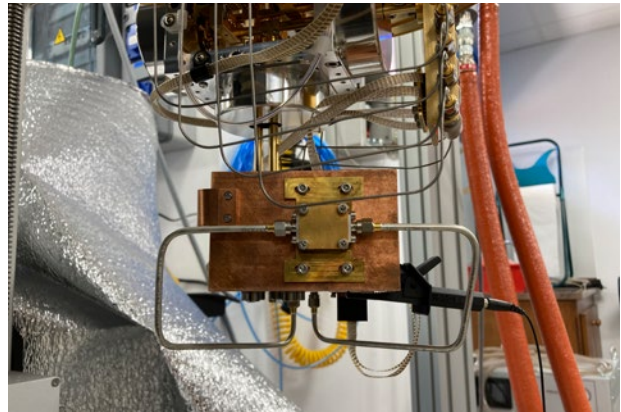
Banco Criogénico sub-Kelvin para el uso de detectores basados en propiedades superconductoras. Detalle detector MKID instalado.
