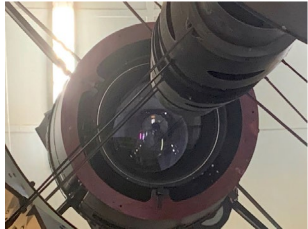
Figura 1. Lente 1 del Corrector Atmosférico montada sobre La Unidad de Corrección Atmosférica instalada en el Telescopio WHT.
