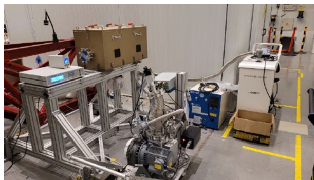
Criostato de GRANCAIN durante las pruebas de ciclo criogénico.
