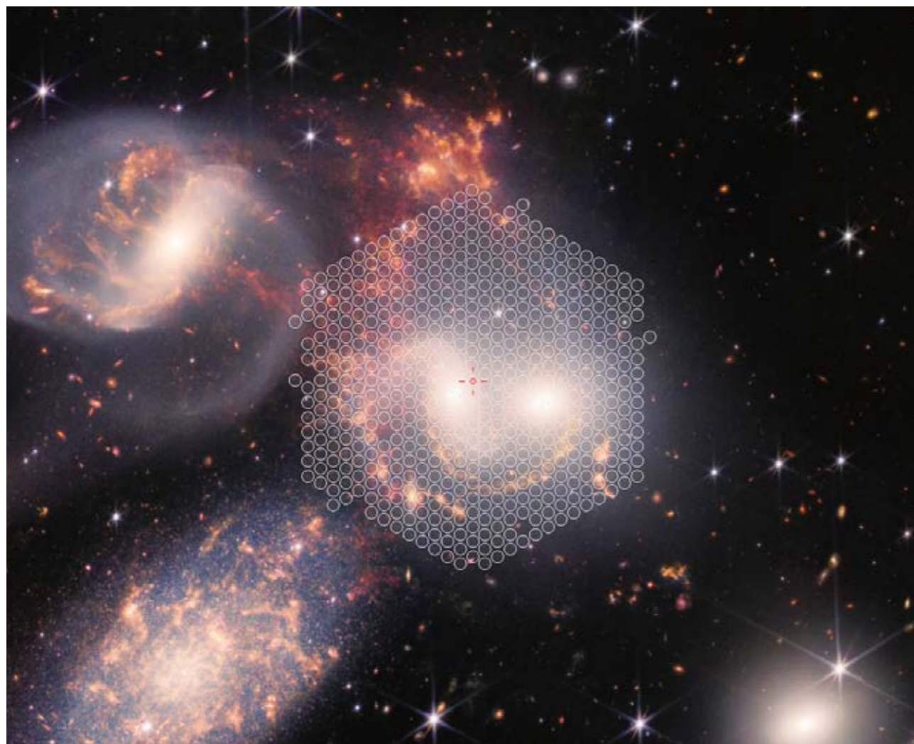
Las 547 fibras del LIFU de WEAVE, que cubren un diámetro de 90 segundos de arco, impresas en la imagen del Quinteto de Stephan obtenida por el JWST.
