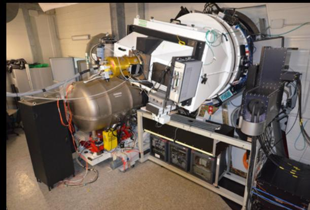
GianoB, el espectrógrafo infrarrojo de alta resolución del TNG. © A. Harutyunyan/TNG
