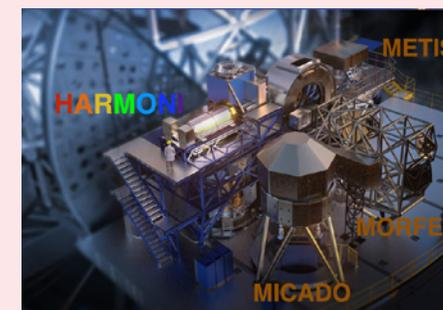
Plataforma Nasmyth del ELT con los cuatro instrumentos de primera luz. MICADO tomará imágenes de alta resolución espacial del Universo en longitudes de onda del infrarrojo cercano; METIS será un generador de imágenes y espectrógrafo para el infrarrojo medio; MORFEO no es un instrumento propiamente dicho, sino un módulo de óptica adaptativa multiconjugada principalmente para MICADO; y HARMONI, el espectrógrafo de campo integral de alta resolución angular.
