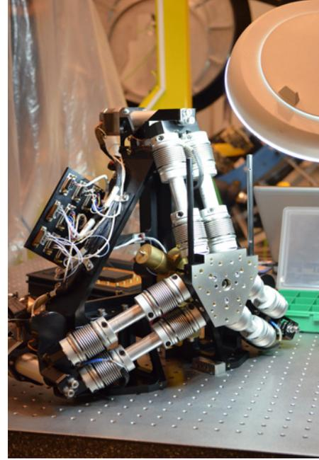
A la izquierda, ajustes previos a la integración de la rueda de filtros en EMIR. A la derecha, sistema de posicionado del detector (DTU).
