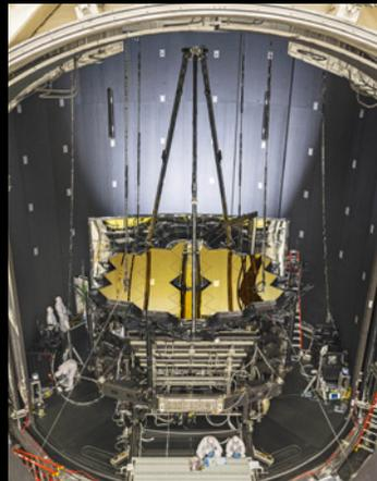
El James Webb, poco antes de entrar en la cámara de vacío donde se le sometió a temperaturas criogénicas para comprobar su funcionamiento en las condiciones extremas del espacio. Los segmentos del espejo primario están recubiertos con una película reflectante de oro para optimizar la observación en el infrarrojo. © NASA/Chris Gunn.
