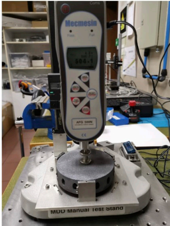
En la imagen puede verse el banco de pruebas para el ensayo de compresión (izquierda) y gráfica representativa de algunos de los resultados del mismo (derecha).
