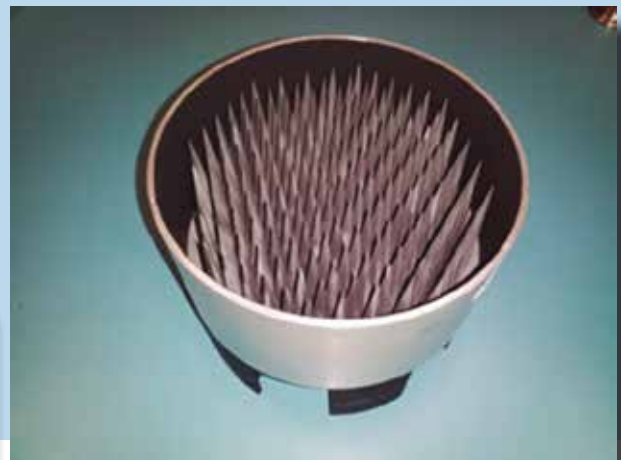
Espectrómetro de Microondas Tenerife (10-20GHz). Arriba: carga térmica de 4 K (noviembre de 2020). Abajo: criostato en la sala AIV del IAC.
