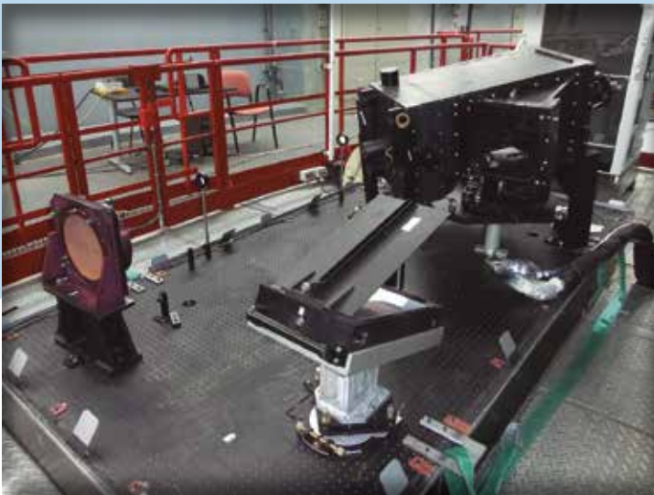
Figura 1: Componentes ópticos de HORuS en la plataforma Nasmyth de GTC. En primer plano se puede apreciar la red de difracción, que dispersa la luz en colores. Al fondo a la derecha se encuentra la cámara y, debajo de la misma, los prismas de dispersión cruzada. Este instrumento reutiliza la mayoría de los componentes ópticos de un antiguo instrumento, el Utrecht Echelle Spectrograph.
