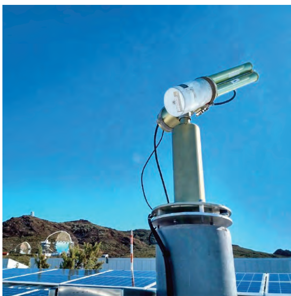
Fotómetro solar CIMEL gestionado e instalado por el CIAI (AEMet) con soporte del SQT en el ORM. El equipo forma parte de la red AERONET liderada por la NASA.
