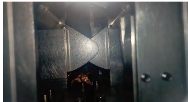
Figura 6. Fast Shutter instalado en el interior del criostato y primeras pruebas en frío.
