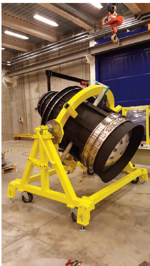
Figura 2. Izquierda: Corrector completo montado con los simuladores de lentes, en la empresa SENER Barcelona en junio, listo para pruebas de rigidez estructural. Derecha: Secundario del telescopio con el FTS, Rotador, y simuladores del Corrector y posicionador, preparado para el alineamiento con el espejo primario del telescopio WHT en noviembre.
