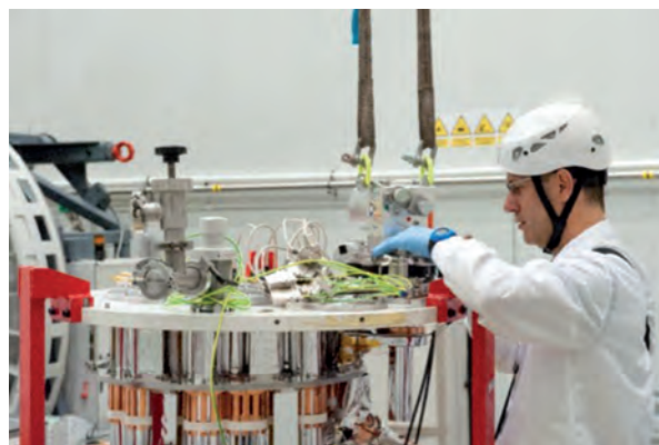
Figura 1.- Cambio de la cabeza fría del TGI en la Sala de AIV del IAC.
