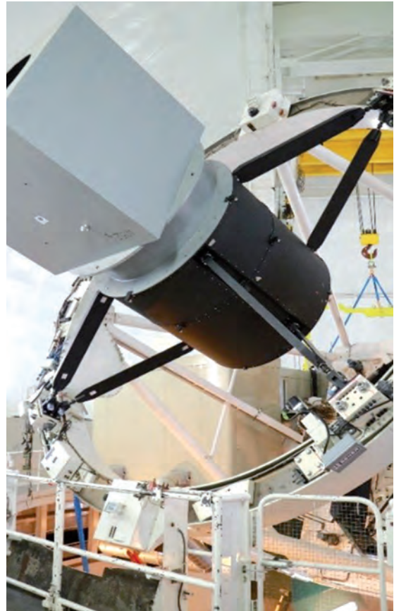
Figura 3.- Pruebas en el telescopio WHT de la estructura soporte y unidad de traslación del foco (FTS).
