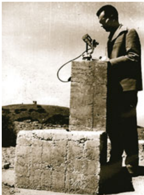
Francisco Sánchez, junto a las instalaciones del Observatorio Meteorológico de Izaña, en 1961, observando el Sol con un piroheliómetro para medir la transparencia atmosférica. (Foto 15)
