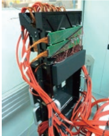
CSU integrada durante las pruebas previas a la aceptación.
