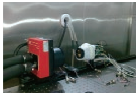
Montaje de caracterización del microbolómetro en la cámara climática del IAC.
