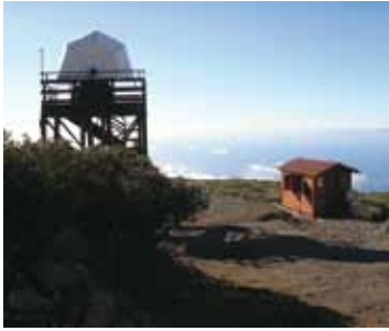
Figura 1. Estación astroclimática en Las Moradas (ORM), consistente en un MASS-DIMM sobre torre de 5 m (izquierda) y una estación meteorológica equipada por sensores meteorológicos estándar (derecha).
