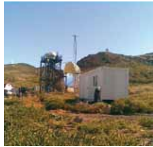
Figura 1. Estación astroclimática en Las Moradas (ORM), consistente en un MASS-DIMM sobre torre de 5 m (izquierda) y una estación meteorológica equipada por sensores meteorológicos estándar (derecha).
