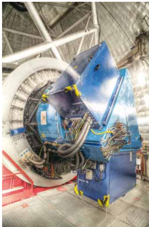
OSIRIS ya instalado en el foco Nasmyth del telescopio GTC.
