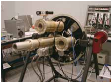
Primer Instrumento QUIJOTE (MFI) en la sala AIV del IAC, con tres cadenas de modulación completamente integradas. Detrás del útil de manejo del instrumento se encuentran los "drivers" de control de los motores, y a la izquierda, sobre la mesa, el ordenador de control.
