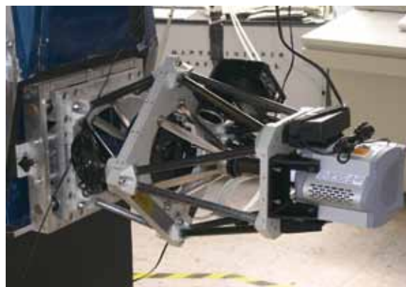
FastCam con su nueva optomecánica instalado en el telescopio TCS.
