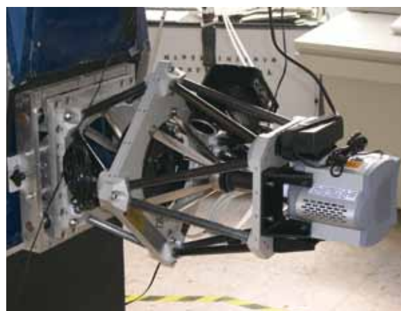
FastCam con su nueva optomecánica instalado en el telescopio TCS.
