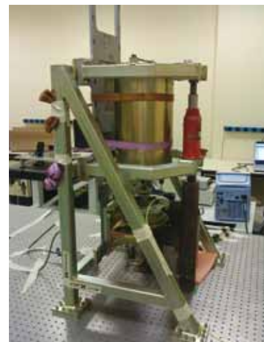
Arriba: Montaje de pruebas de la electrónica de control del Actuador de Posición (PACT) del telescopio E-ELT en el Laboratorio de Óptica del IAC. El PACT tiene una carga de 90 Kg que simula el segmento del telescopio E-ELT.
