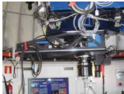
La nueva caja de A&G del telescopio IAC-80 durante el periodo de pruebas.
