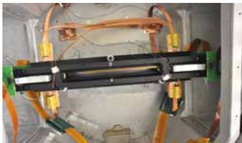
Prototipo de 6 barras de la CSU instalado en el criostato de pruebas EMCTS.
