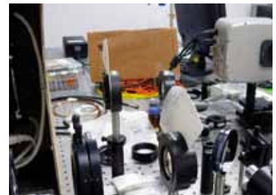
Montaje en el Laboratorio de Óptica para la medida de la Relación Focal de las fibras ópticas.
