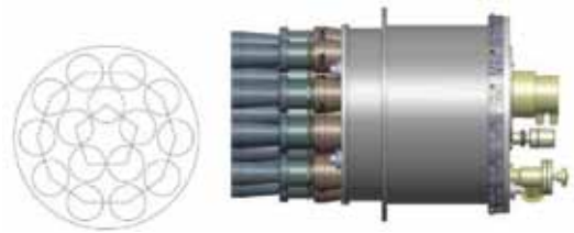
Izquierda: Posible configuración del plano focal del segundo instrumento. Derecha: Diseño detallado del criostato del segundo instrumento.
