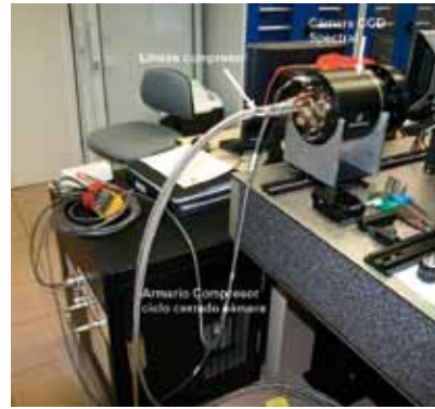
Arriba: Cámara CCD de EDiFiSE montada en la mesa óptica del laboratorio LISA durante las pruebas de caracterización. Abajo: Detalle detector.
