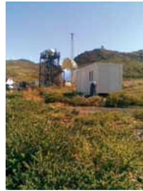
Izquierda: DIMMA-MAGIC, vista de la torreta de 9,2 m instalada en las proximidades del telescopio MAGIC, así como la torreta de metrología y la caseta. Derecha: detalle de la torreta de 9,2 m.
