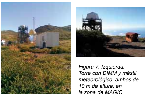
Figura 8. Derecha: imagen panorámica de las Moradas. En la torre de 5 m se encuentra el MASS-DIMM. La cúpula es de ASTELCO. La caseta fue fabricada por Jiménez-Cortabitarte (Soria) y es donde se almacenan los equipos de control.
