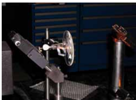
Detalle de las pruebas con lente plano-convexa para el sistema de expansor fuera de eje.
