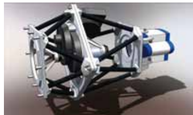
Diseño de la optomecánica de FastCam realizado por IDOM.
