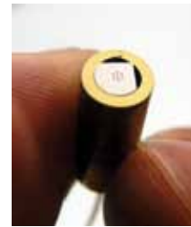
Detalle del pulido de un conector de fibra.
