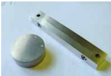
Abajo: Conector y rendija para haz de fibras EB#2.
