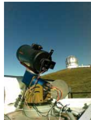
Figura 9. MASS-DIMM y cúpula desplegada en la torre de Las Moradas. Al fondo, en primer plano, el telescopio GTC y en segundo plano, el telescopio NOT.
