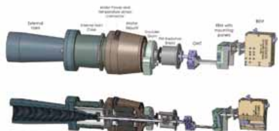
Diseño detallado de uno de los 15 polarímetros para el segundo instrumento.
