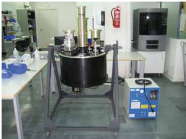
Imagen del primer instrumento en el útil de manejo que se ha fabricado en IDOM. Se muestra también el compresor (en el suelo, junto al instrumento).
