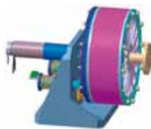
Vista en tres dimensiones del diseño mecánico del actuador del telescopio E-ELT. Consta de dos etapas, una gruesa basada en un motor de continua, y una fina basada en un voice coil.
