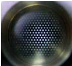
Izquierda: Detalle 331 taladros conector haz EB 32.
