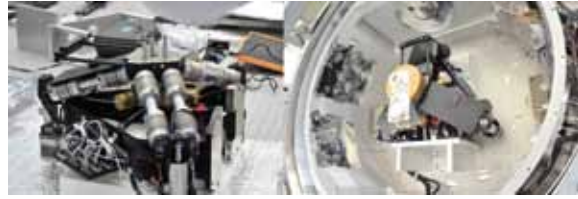
DTU antes y después de su integración en el criostato de pruebas EMCTS.
