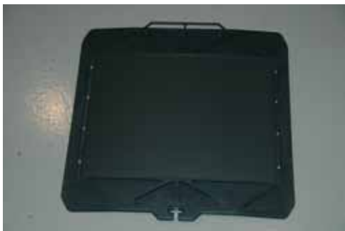
Figura 6. Máscara Multislit. Las láminas se montan sobre los marcos una vez mecanizadas según requisitos del astrónomo.
