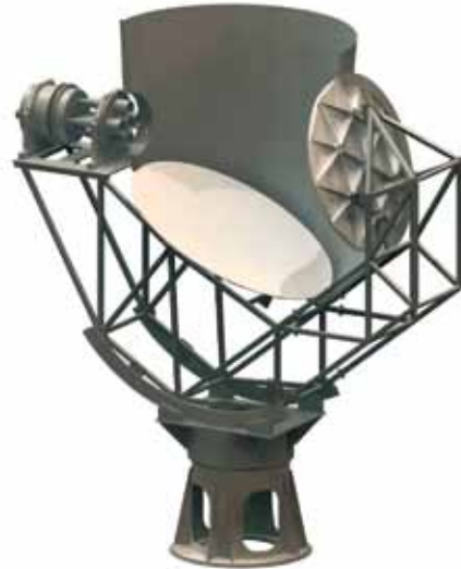
Arriba. Figura 3. Diseño preliminar del telescopio de QUIJOTE.
