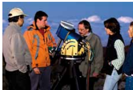
Figura 1. MASS-DIMM durante la campaña de calibración con el DIMM en el ORM con parte del equipo participante.
