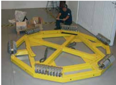
Figura 4. Útil de transporte. Permite trasladar el instrumento amortiguando las vibraciones.
