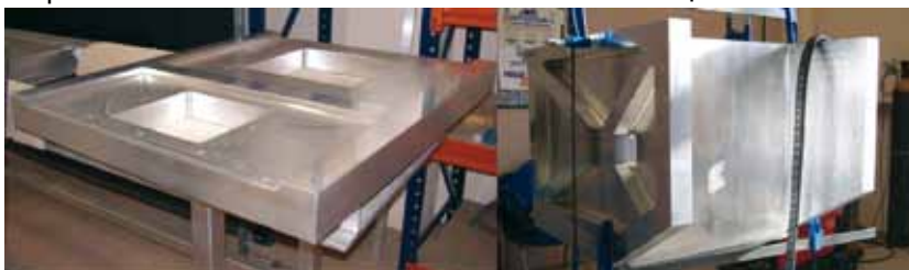
Principales componentes del Banco Óptico preparadas para el proceso final de soldadura.
