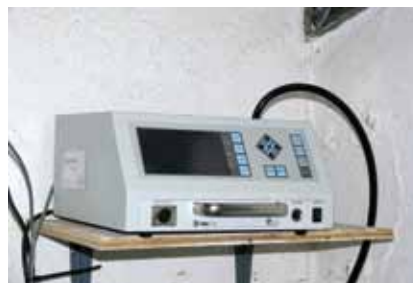
Figura 4. Contador de partículas del aire instalado en el ORM.
