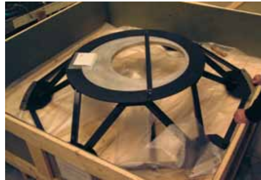
Figura 5. Estructura del simulador del telescopio. Sobre este elemento se montará una óptica que simulará la luz proveniente del telescopio.
