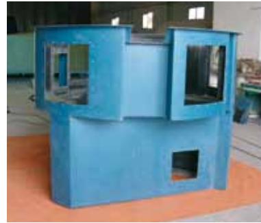
Figura 3. Carenado del instrumento. Aísla el instrumento del entorno.
