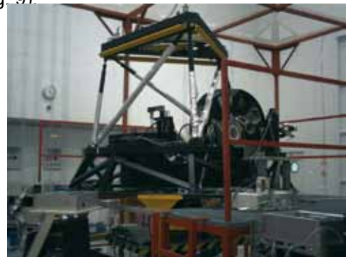
Figura 7. Integración sobre el ISB en el suelo. Posición que ha permitido realizar una integración y pruebas iniciales de forma cómoda. Alrededor del instrumento un sistema de andamios para facilitar el acceso.
