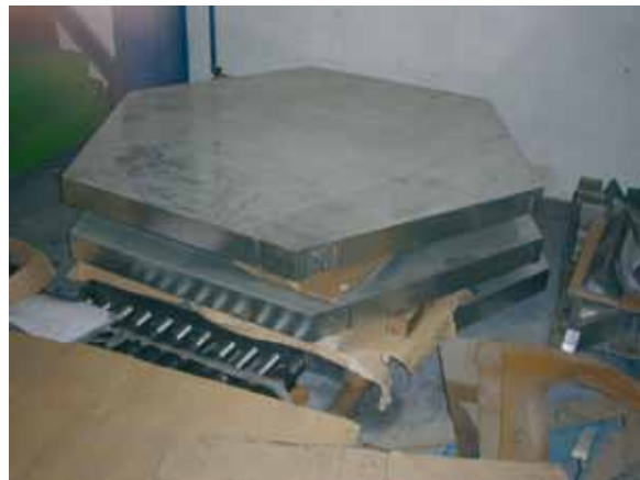
Diseño fotos de componentes fabricados de los HPA. Arriba: Paneles hexagonales. Abajo: Trípodes del "whiffle tree".
