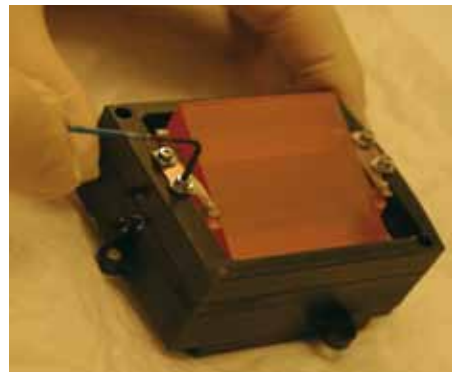
Pseudogrisma Formado por sándwich prisma-red-prisma.
