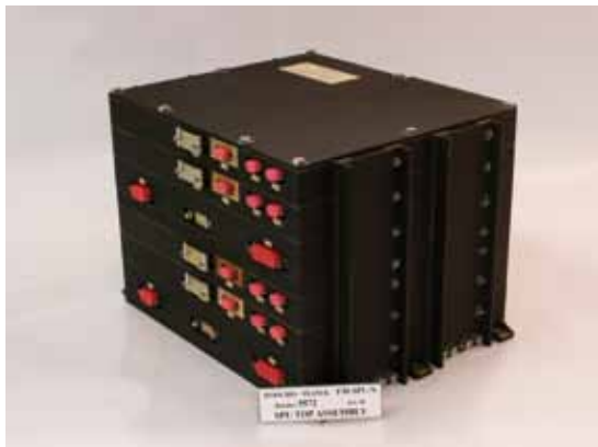
Figura 2: modelo de vuelo del equipo SPU del instrumento PACS del satélite HERSCHEL. La sección nominal se encuentra en la parte superior del equipo y la redundante.
