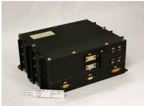
Figura 1: modelo de vuelo del equipo REBA, sección redundante, del instrumento LFI del satélite Planck. (Foto CRISA).
