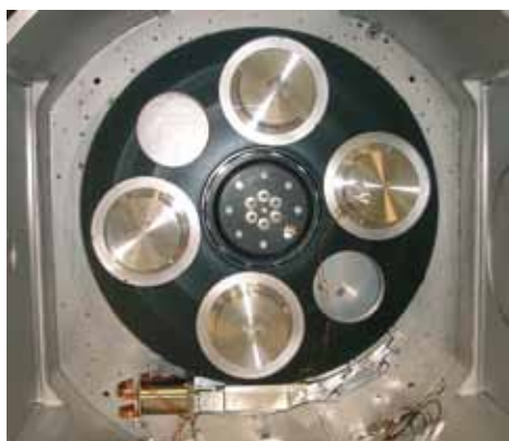
Prototipos del soporte del banco óptico (arriba) y de la rueda de grismas montado (abajo) dentro del EMCTS.
