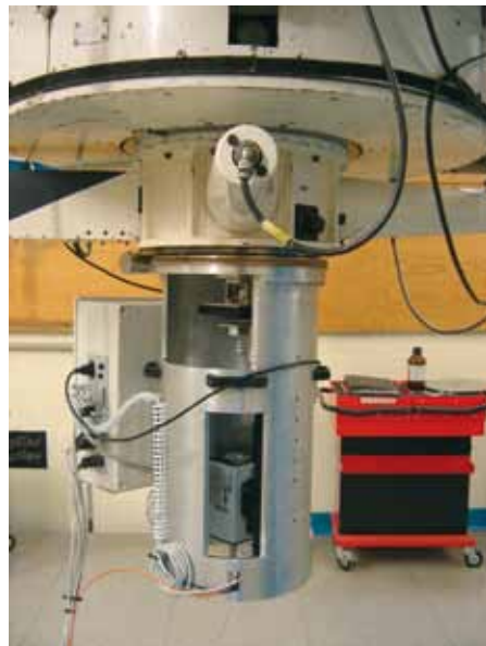
Izquierda: instrumento g-SCIDAR instalado en el telescopio JKT (ORM, La Palma). Derecha: vista parcial del interior del instrumento.
