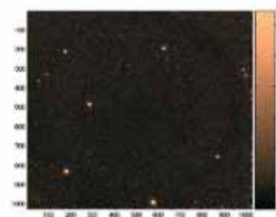
Primera imagen de un campo estelar obtenida con el instrumento TON+ en agosto 2005. Corresponde a HD182919 (5 Vulpecula) con una integración de 12 s. y sin corregir de flat-field.
