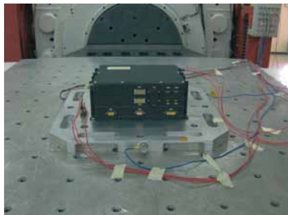
Modelo de vuelo del LFI-REBA, sección nominal, en la mesa de vibración listo para el ensayo.
