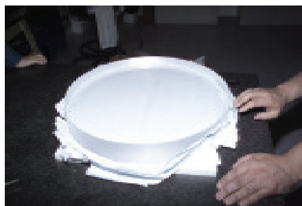
Ventana del criostato de pruebas de EMIR, similar a la primera lente del colimador.
