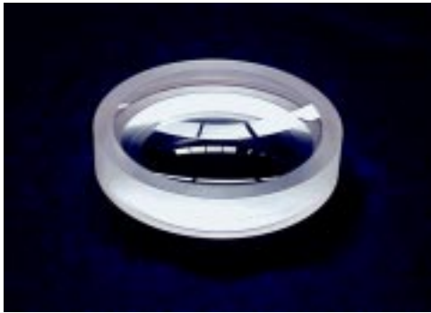
Prototipo de la lente singlete S3 de la cámara fabricado en los talleres de la UNAM y propuesta de diseño mecánico para la estructura soporte.
