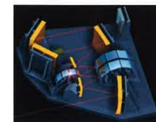
Figure 4: La instrumentación espacial debe ser compacta y robusta. De ahí el uso exclusivo de óptica refractiva y ruedas de selección espectral.
