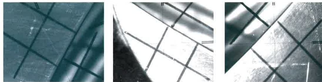
Figura 5: Marcas vistas con el telescopio a través de la ventana del criostato.
