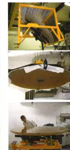
De arriba abajo, espejo terciario en su herramienta de transporte, en la herramienta de manipulación y en su herramienta de volcado, revisado por el responsable de Óptica de GRANTECAN, Javier Castro. Créditos: IAC.
