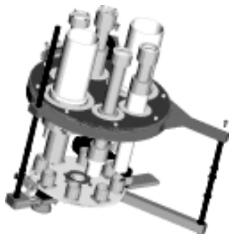
Montaje de las ruedas de cámaras y grismas
