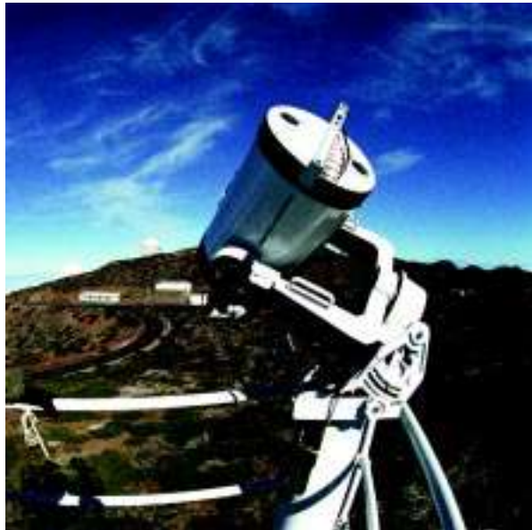
El telescopio en que se montan SDIMM y SHABAR, en la parte alta de la torre. Foto: Miguel Briganti (SMM/IAC).
