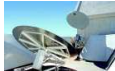
Cosmo15. La radiación se refleja en el espejo giratorio hacia el parabólico que la focaliza en la antena que está en el interior del criostato, tras la cual se inician las diferentes etapas de amplificación de la señal.
