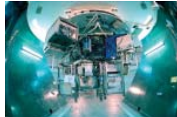
El espectrógrafo LIRIS, instalado en el telescopio "William Herschel". Foto: Miguel Briganti (SMM/IAC).
