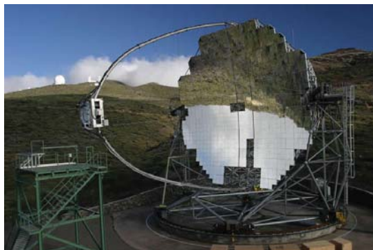
El telescopio MAGIC, en el Observatorio del Roque de los Muchachos, mostrando la mayor parte de los 934 espejos que forman el reflector de 17 m de diámetro.
