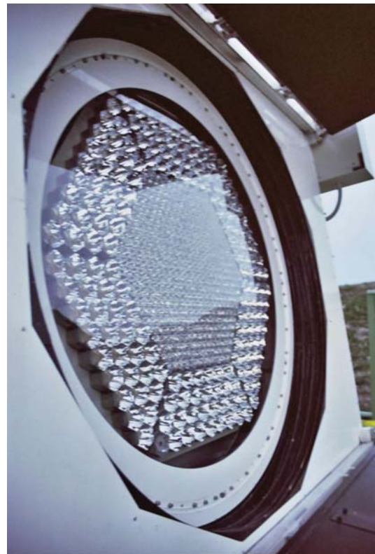
Vista frontal de los 577 píxeles de la cámara de MAGIC.
