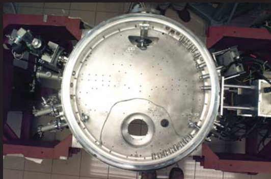
Banco óptico integrado en el anillo central del tanque de vacío.
