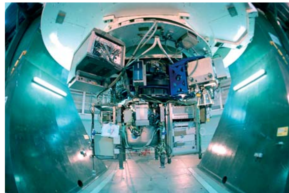
LIRIS, integrado en el Foco Cassegrain del WHT.
