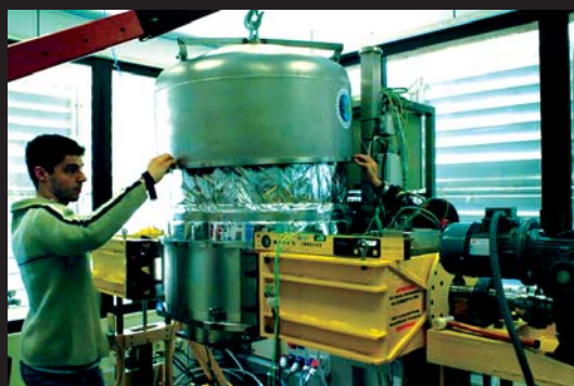
Integración de la tapa trasera del tanque de vacío.
