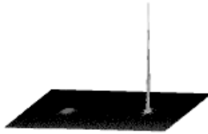
Figura 1.- Imagen de una estrella en el infrarrojo que se obtendría con el GTC, limitada por la turbulencia atmosférica (izquierda) y limitada por difracción (derecha).
