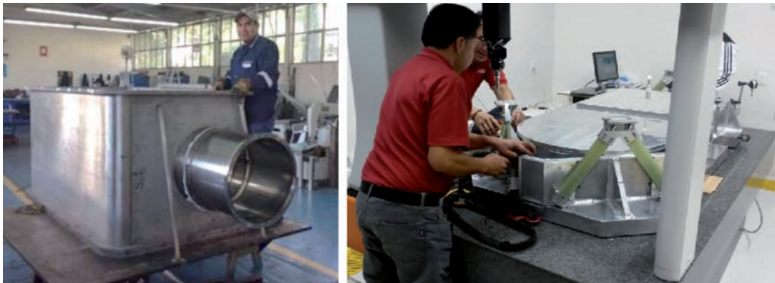
Últimas etapas de la fabricación del criostato y banco óptico de FRIDA en CIDESI.
