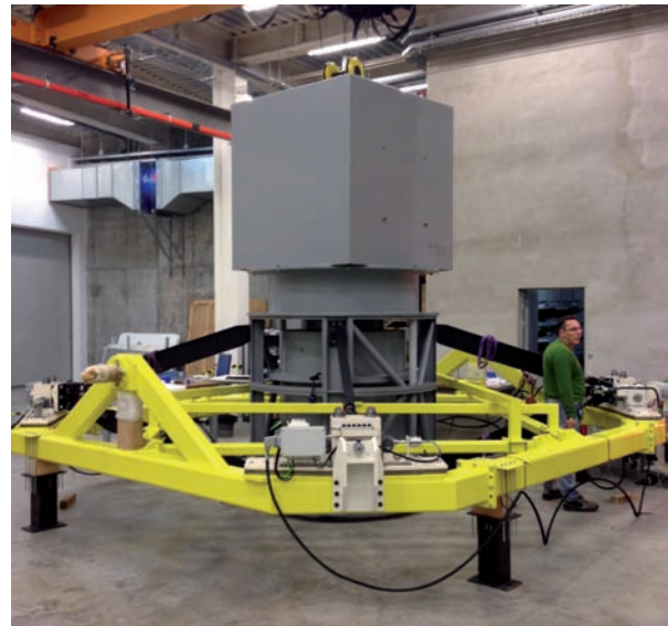
Vista general del nuevo foco primario –estructura soporte con control de foco, y simuladores estructurales del corrector focal, rotador y posicionador de fibras.
