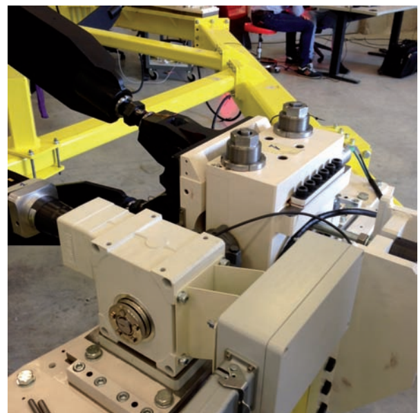
Detalle de una unidad del sistema de actuación del control del foco.
