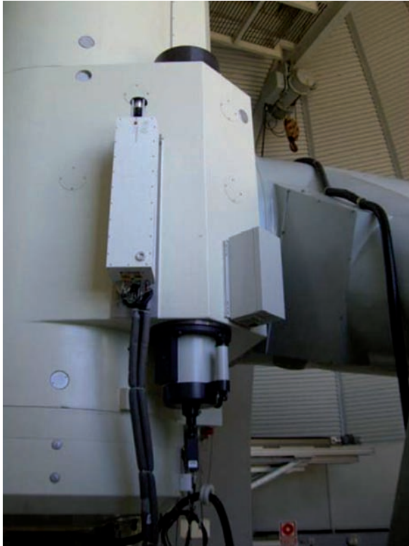
Laser Quantronix Nd:YAG (Hawk II) empleado en los enlaces con SOTA.
