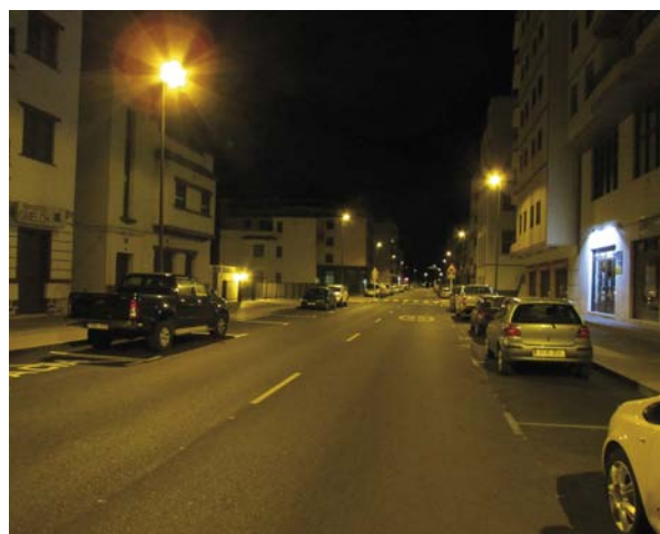
Izquierda, calle con LEDs incorrectos 4.000°K (luz neutra). Derecha, calle con LEDs PC-ÁMBAR, Los Sauces (correctos).
